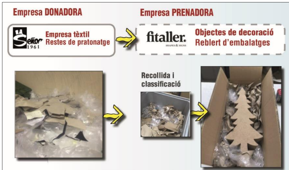
Figura 2.12 - Schema della sinergia 2 (sostituzione dei materiali) (Fonte: SÍMBIOSY, 2017) 21
